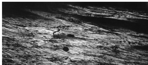
Рис. 1. Частицы износа вблизи поверхности катания в зоне интенсивной пластической деформации: а – \times 100 , б–г – \times 200
