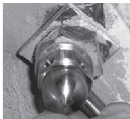
Рис. 4. Мобильный виброизмерительный комплекс и трехкомпонентный пьезоэлектрический виброакселерометр
