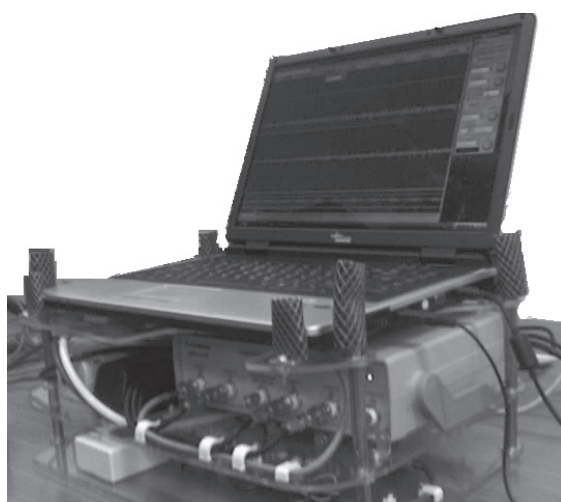
Рис. 4. Мобильный виброизмерительный комплекс и трехкомпонентный пьезоэлектрический виброакселерометр
