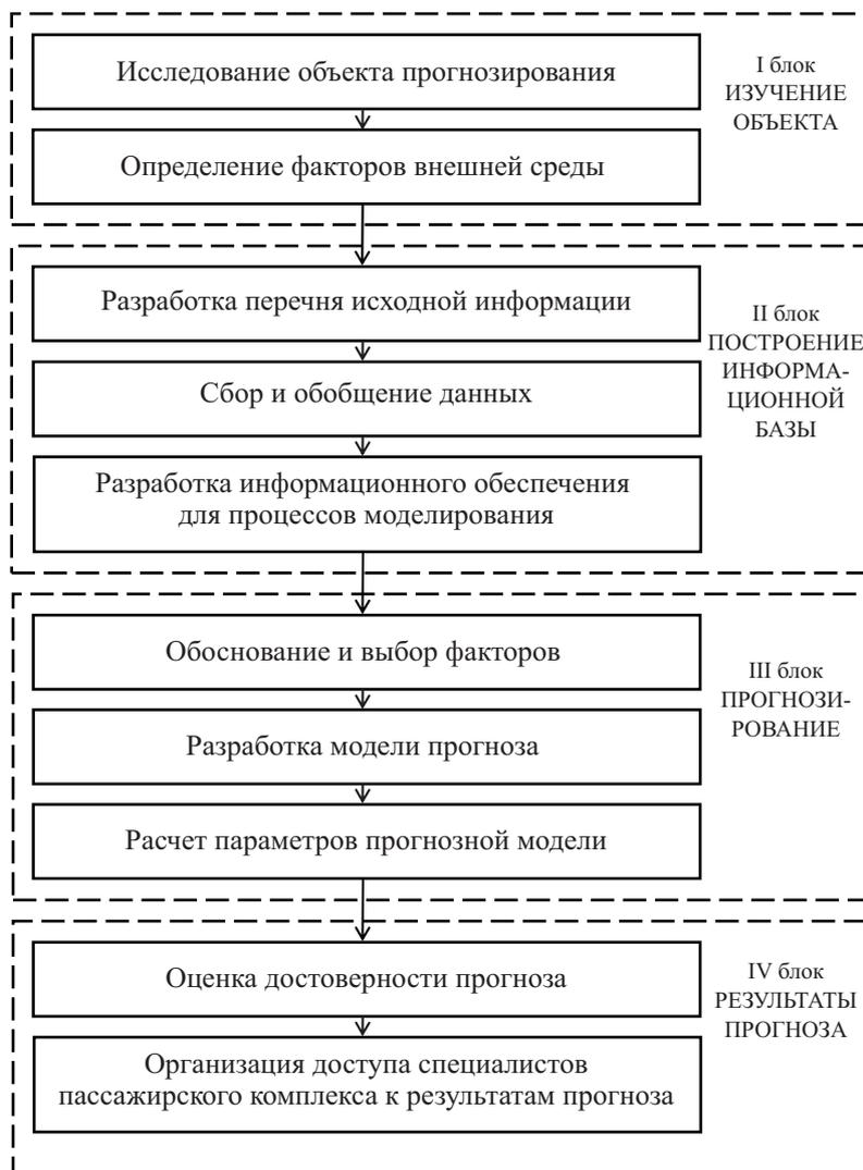
Рис. 2. Укрупненная схема прогнозирования пассажиропотоков на базе информационных технологий
