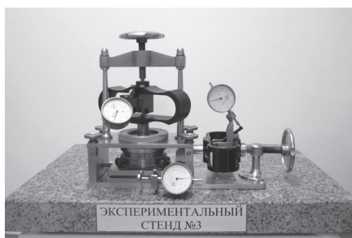
Рис. 4. Определение коэффициента трения на сдвиговом приборе ВСВ-1
