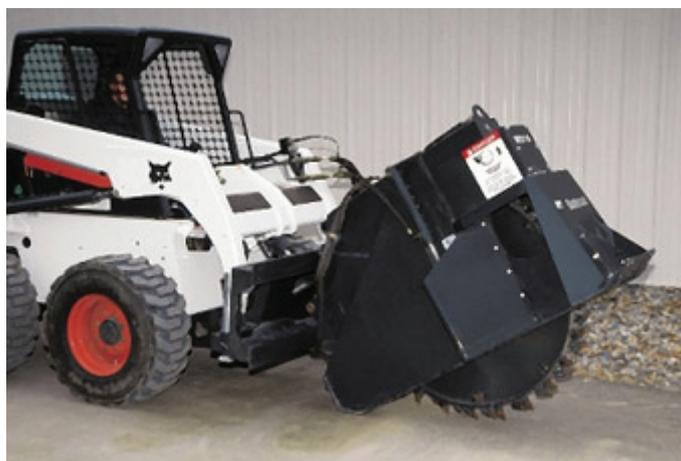
Рис. 5. Навесное устройство «Пила дисковая»
