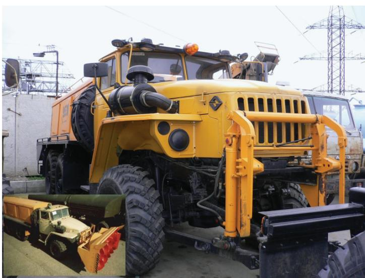
Рис. 1. Автомобиль для расчистки взлетно-посадочных полос аэродромов «УРАЛ-4320-41»
