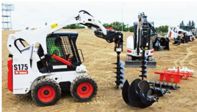
Рис. 6. Навесное устройство «Бур шнековый»
