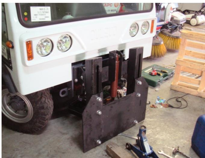
Рис. 16. Изготовленное навесное устройство смонтировано на машину «Dulevo»-
