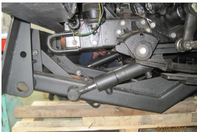
Рис. 12. Готовое навесное устройство смонтировано на автомобиль «Силант»
