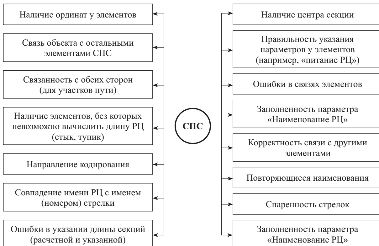
Рис. 2. Виды проверок СПС на соответствие НСИ
