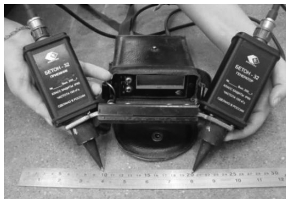
Рис. 1. Бетон-32 с базой прозвучивания 100 мм
