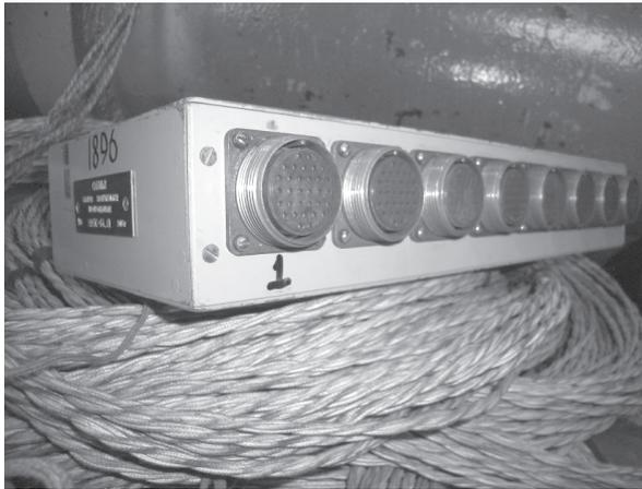
Рис. 6. Многоканальная микропроцессорная тензометрическая система ММТС-64.01
