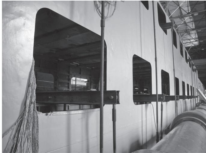
Рис. 4. Комплект пневматических приспособлений (а) и реализация вертикальных нагрузок на первый и второй этажи кузова вагона (б)
