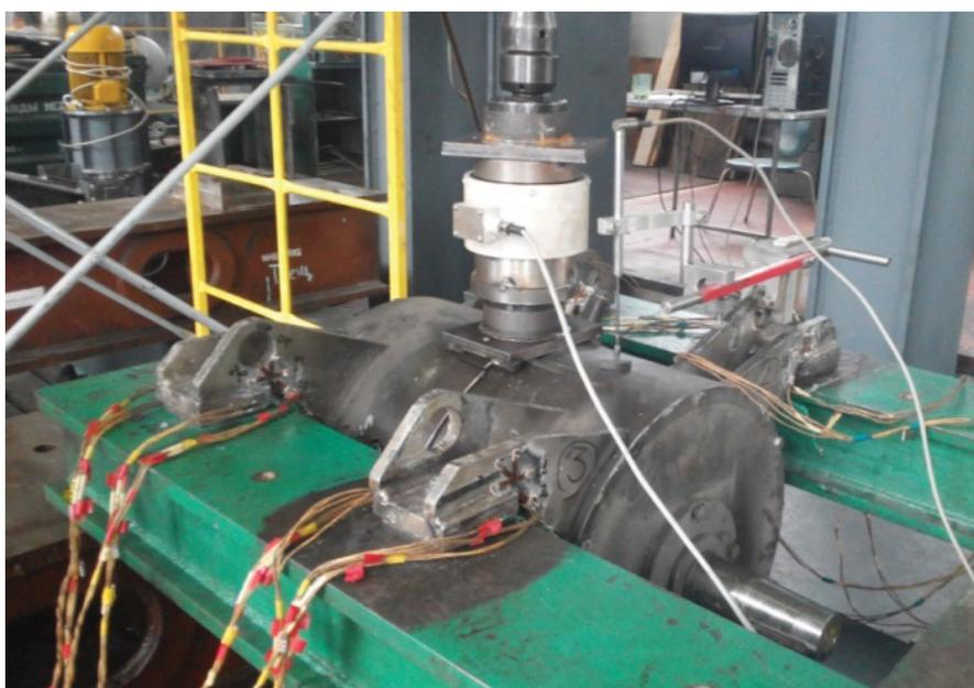
Рис. 5. Установка генератора в испытательной машине при усталостных испытаниях
