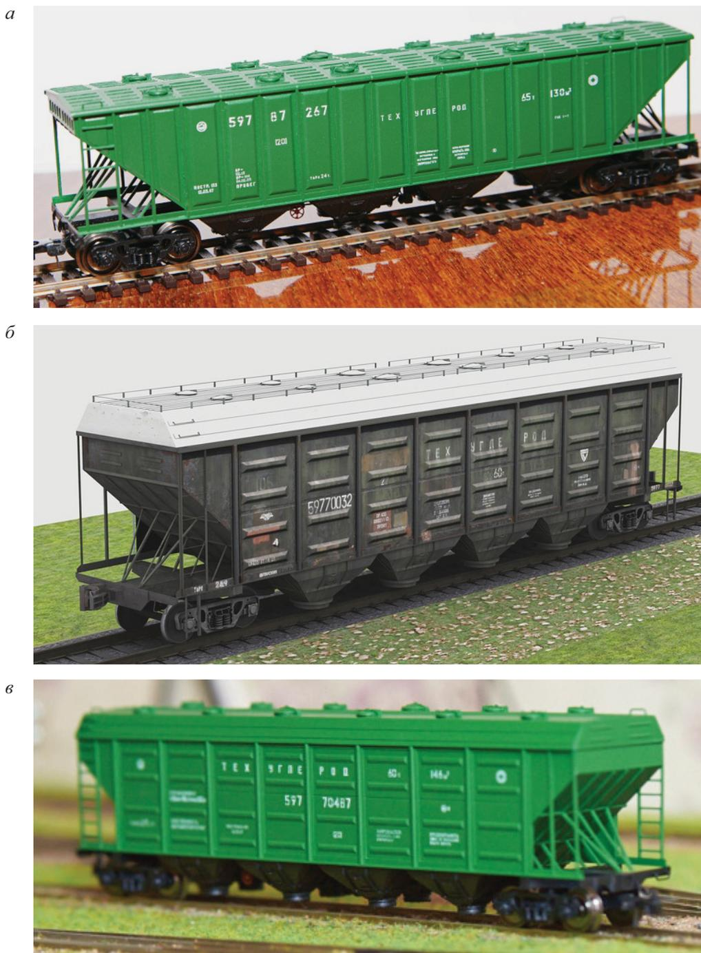
Рис. 1. Вагоны-хопเปอร์ы моделей 20-403 (а), 25-4001 (б) и 25-4046 (в)
