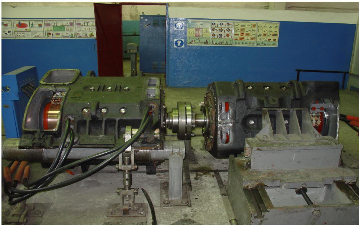
Рис. 1. Приемосдаточные испытания ТЭД типа ЭД118А с изоляцией класса «Н» после ремонта на ЯЭРЗ
