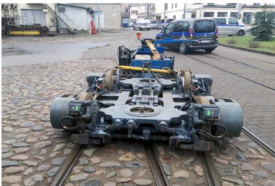
Рис. 4. Вид тележки – слева и справа колес (тяговые индивидуальные электродвигатели)
