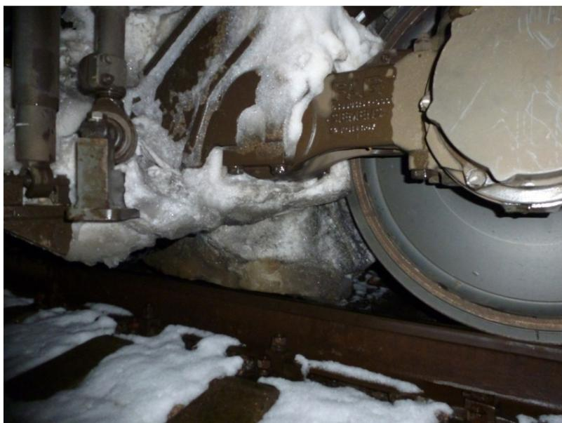
Рис. 1. Ледяные образования на тележке высокоскоростного подвижного состава
