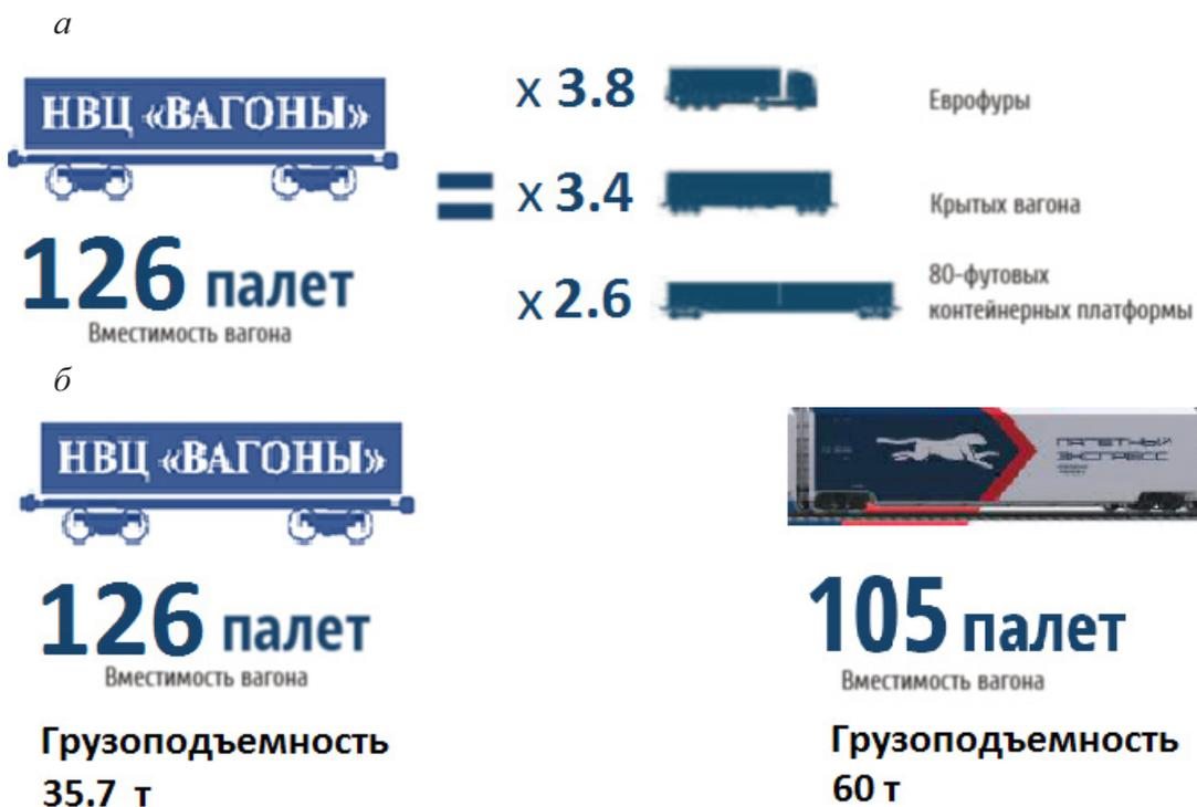
Рис. 4. Сравнение концепта вагона-паллетовоза на пассажирских тележках с аналогами:
