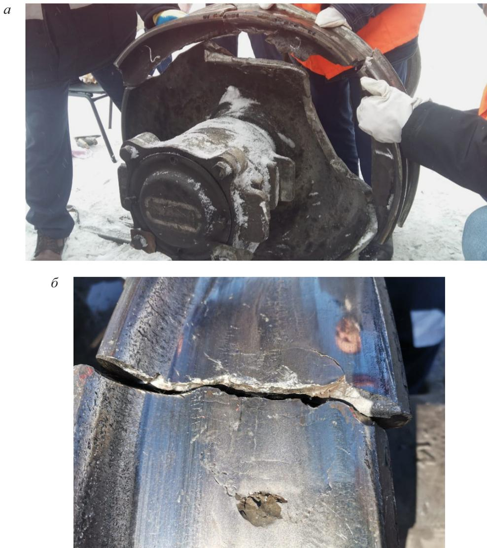
Рис. 1. Разрушение колеса грузового вагона в эксплуатации:
