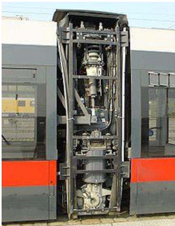
Рис. 2. Ходовая часть и тяговый двигатель вагона ULF
