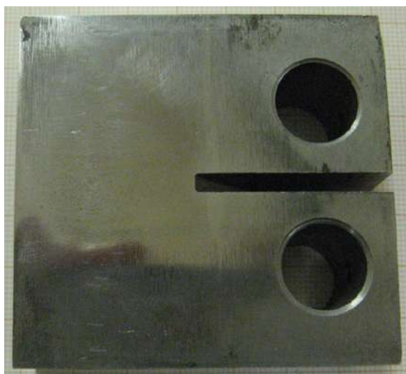
Рис. 1. Прямоугольный образец с односторонним боковым надрезом (образец ВР) для испытаний на циклическую трещиностойкость (скорость роста усталостной трещины)
