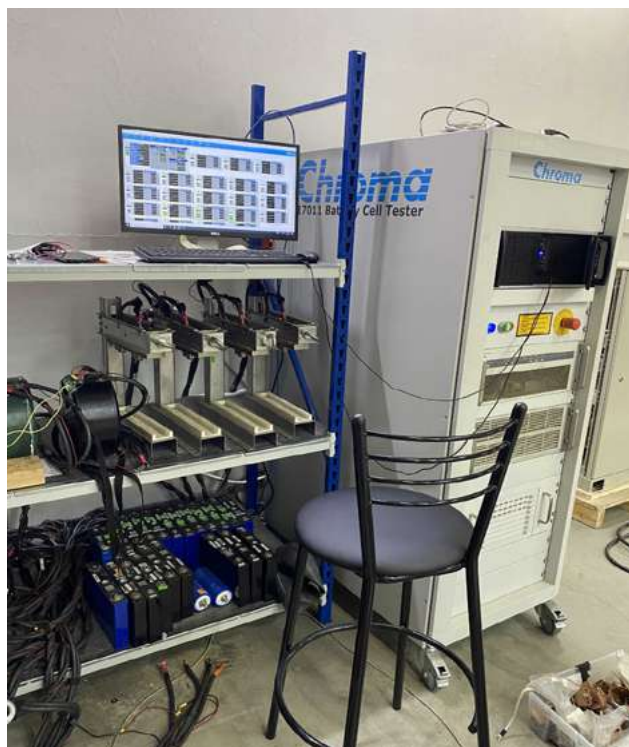
Рис. 6. Испытательный стенд Chroma 17011 Battery Cell Test
