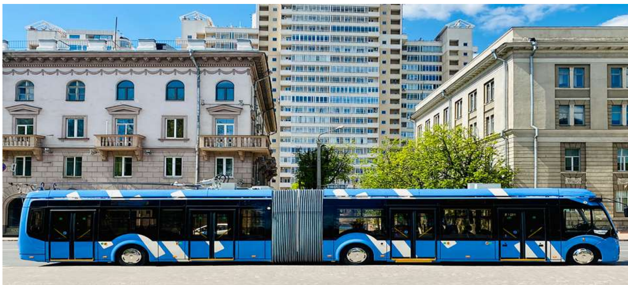
Рис. 4. Троллейбус модели 433.030 Vitovt Max II на базе Phileas в Санкт-Петербурге: длина (м) — 18,75; пассажировместимость (чел.) — 160; мест для сидения — 42; максимальная масса (кг) — 28 000; мощность электродвигателя (кВт) — 180
