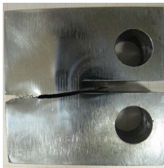
Рис. 2. Образец ВР с усталостной трещиной на боковой поверхности после окончательного разрушения
