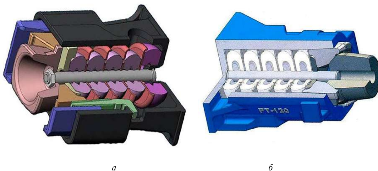
Рис. 2. Модели фрикционно-полимерных поглощающих аппаратов: а — поглощающий аппарат ПМКП-110; б — поглощающий аппарат РТ-120
