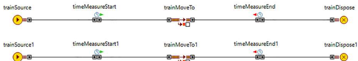
Рис. 2. Блочная часть имитационной модели абстрактной экспериментальной железнодорожной линии имитирования движения с ускорением и замедлением
