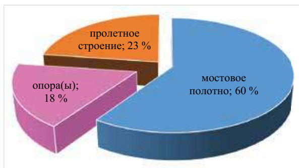
Рис. 4. Показатели повреждений и дефектов в элементах мостового сооружения в соответствии с ТЭП «Безопасность и комфортность движения»
