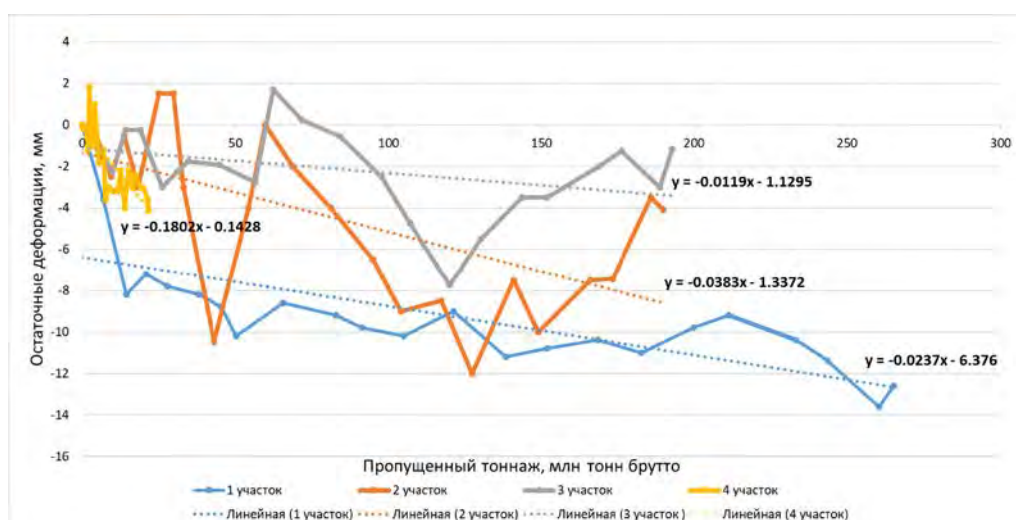
Рис. 3. Результаты измерений остаточных деформаций основной площадки земляного полотна. Конец переходной кривой (КПК), средние значения
