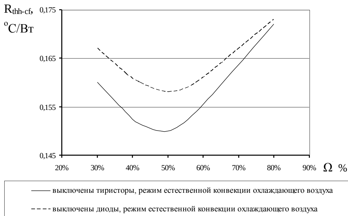
Рис. 3. Зависимость теплового сопротивления «контактная поверхность – охлаждающая среда» от относительного заполнения внутреннего объема охладителя промежуточным теплоносителем ( \Omega , %)
