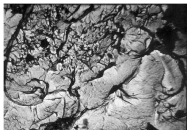
Рис 2. Кластеризация трещин в материале цементного камня
