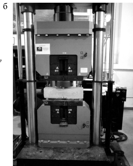
Рис. 3. Схема нагружения образца для измерения CMOD (а) и внешний вид установки (б): 1 – деталь (надрез), 2 – датчик, 3 – ребро призмы
