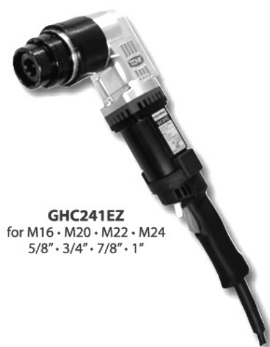
Рис. 6. Ключи для сборки фрикционных соединений на высокопрочных метизах с контролем натяжения по срезу торцевого элемента
