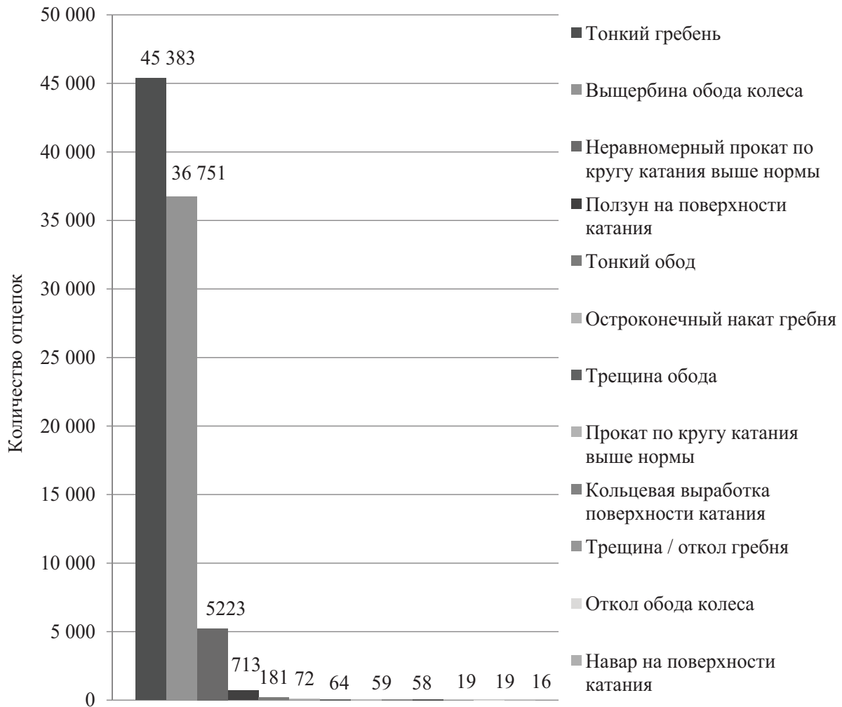
Рис. 3. Диаграмма распределения отцепок вагонов по основным неисправностям колесных пар на Восточно-Сибирской железной дороге за период 2016–2019 гг.
