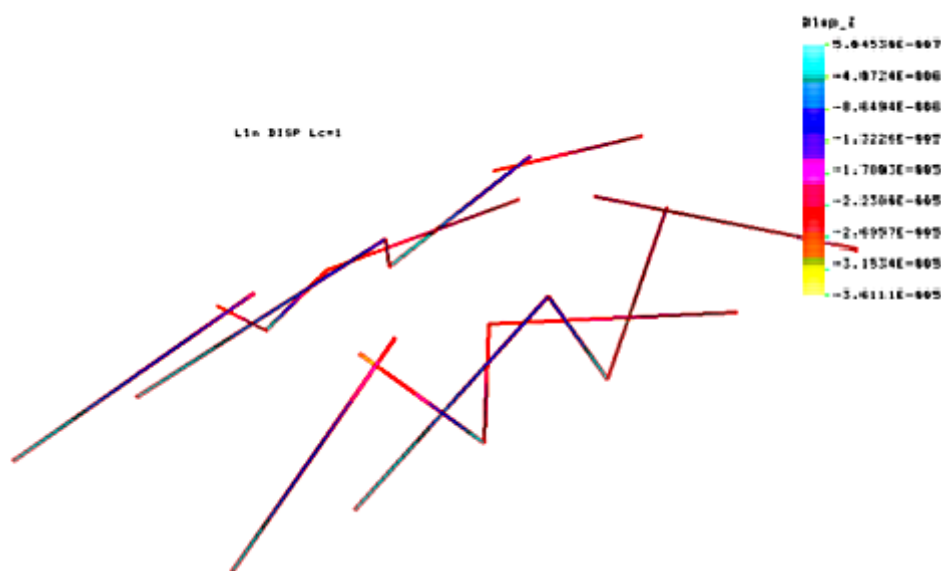
Рис. 6. Перемещения в гибких элементах крепления
