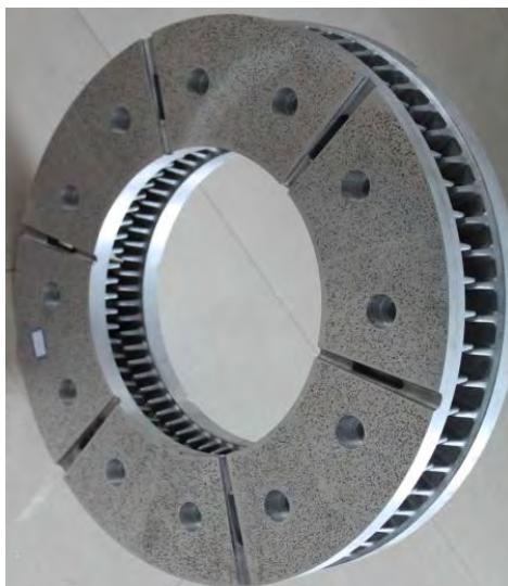
Рис. 1. Пористые спеченные керамические каркасы ( а – из Al_2O_3 , б – из SiC) и тормозной диск для железнодорожных составов из алюмоматричного ММК, полученный по технологии жидкофазной пропитки керамических пористых каркасов ( в ) [9]
