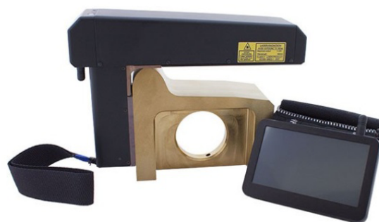
Рис. 7. Лазерный профилометр поверхности катания колесных пар
