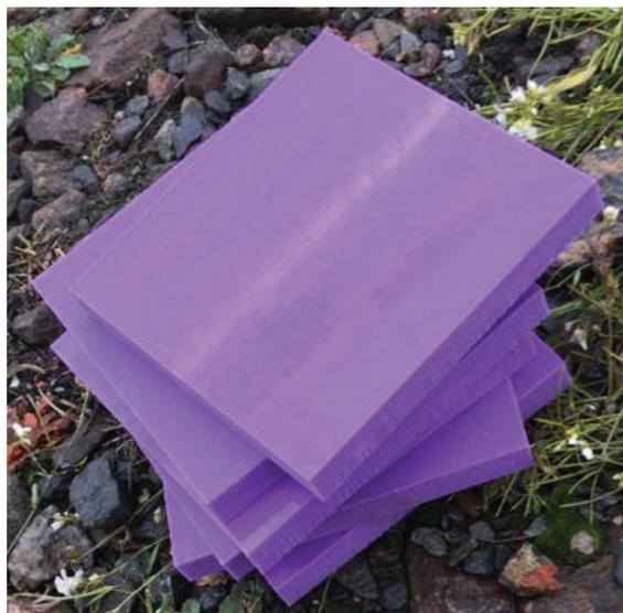
Рис. 4. Прокладка повышенной упругости Syldyn NF (опытная)
