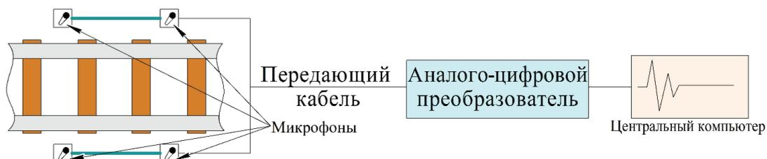
Рис. 11. Схема работы методом акустического шума
