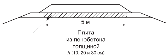
Рис. 3. Конструктивная схема насыпи с плитой из пенобетона различной толщины
