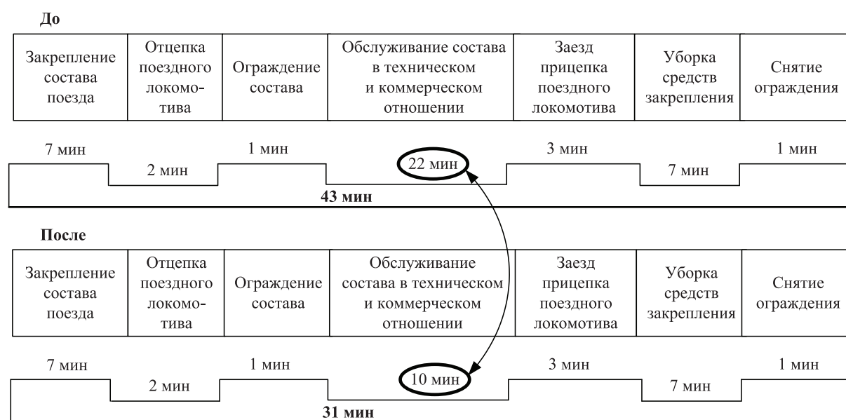
Рис. 1. Карта потока создания ценности процесса в ходе обработки поезда в парке приема сортировочной станции
