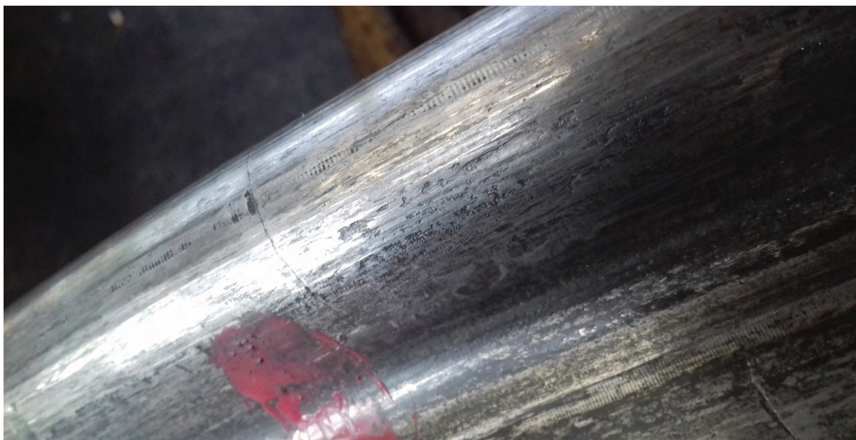
Рис. 1. Внешний вид трещины гребня бандажа
