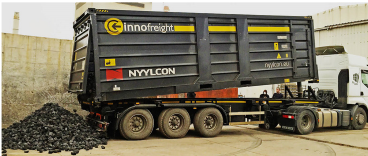
Рис. 2. Съемные кузова производства компании INNO FREIGHT: a – вагон-платформа со съемным кузовом открытого типа; б – вагон-платформа со съемным кузовом типа хоппер-дозатор; в – съемный кузов открытого типа с возможностью выгрузки через торцевую стену
