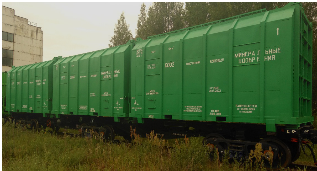
Рис. 3. Сменные кузова разработки компании ООО «ВНИЦТТ» закрытого типа с разгрузкой через торцевую стену
