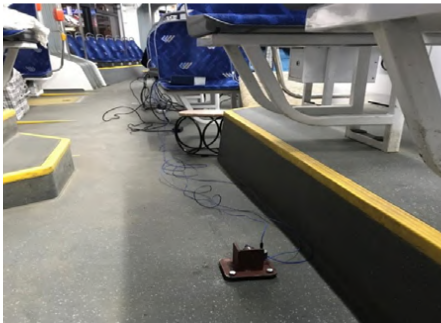
Рис. 2. Установка датчиков в вагоне
