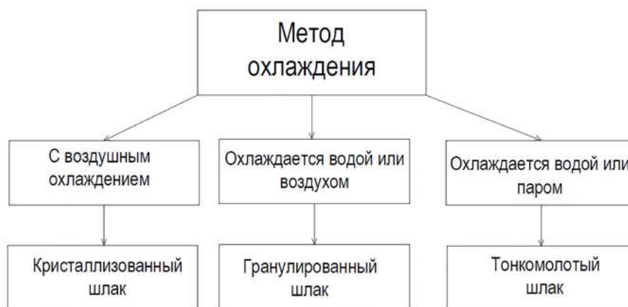
Рис. 4. Разделение шлака по способу охлаждения
