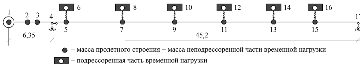
Рис. 3. Динамическая модель системы мост–поезд
