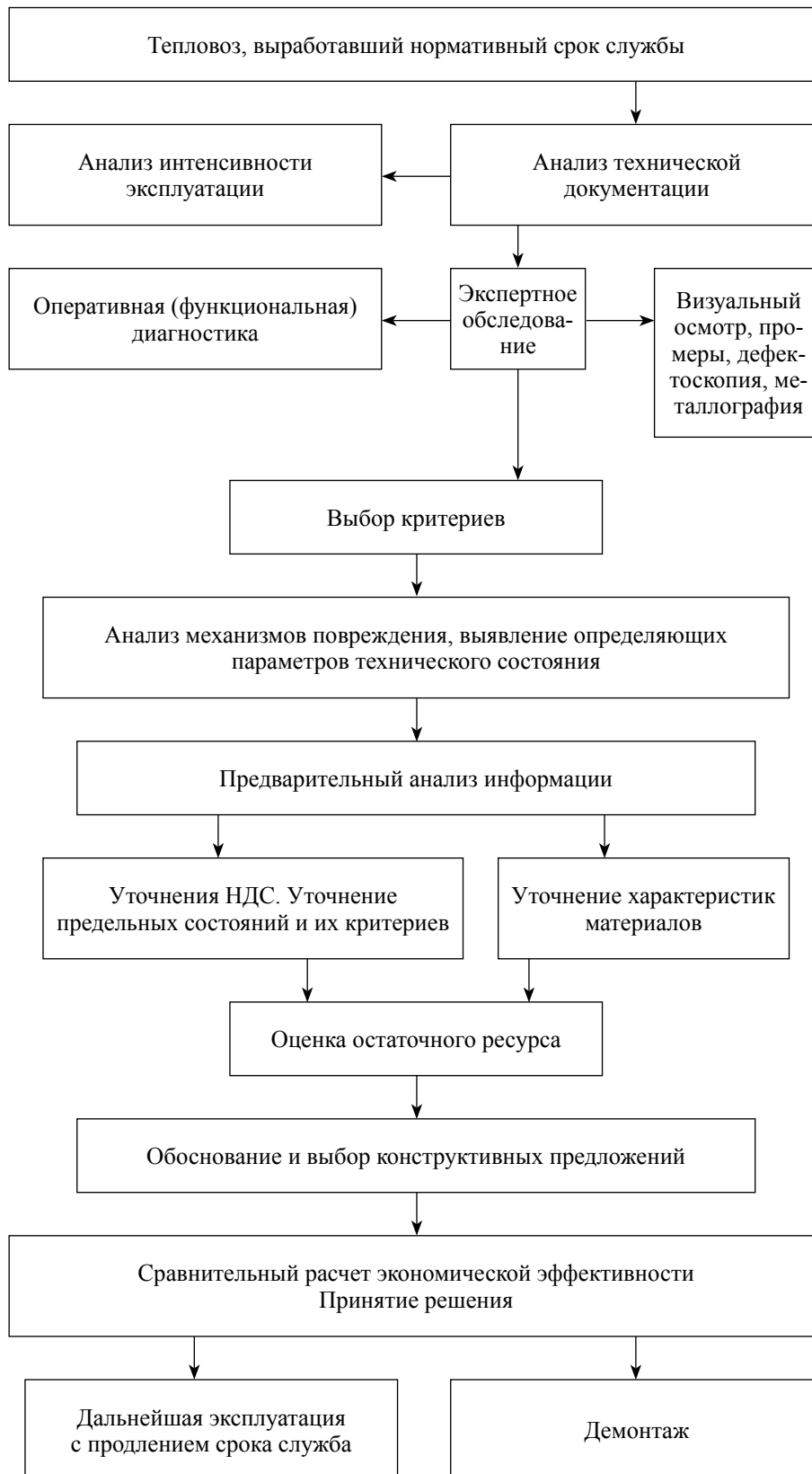
Рис. 2. Структурная схема процедуры определения остаточного ресурса и продления сроков службы несущих конструкций тепловоза
