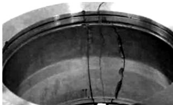
Рис. 2. Трещина наружного кольца подшипника качения
