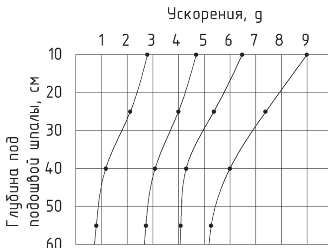
Рис. 4. Затухание вертикальных ускорений по глубине балластного слоя при различных величинах осевой нагрузки:
