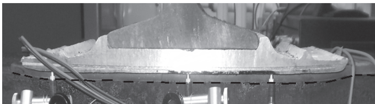
Рис. 4. Снятие волокна древесины деревянной шпалы
