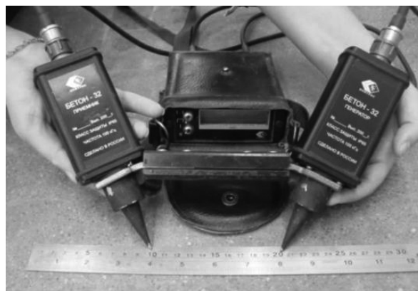
Рис. 1. Бетон-32 с базой прозвучивания 100 мм
