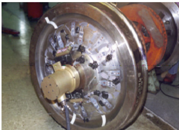
Рис. 3. Оборудованные приборами колеса для измерения сил контакта колеса/рельса вагона Т-16
