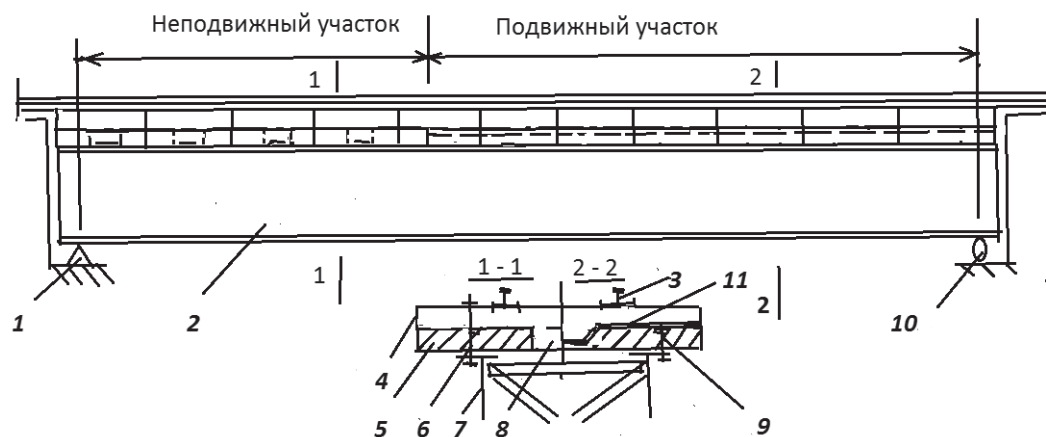
Рис. 8. Пролетное строение с двухплитным мостовым полотном:
