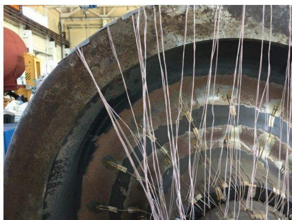
Рис. 9. Схема расстановки тензорезисторов на диске колеса
