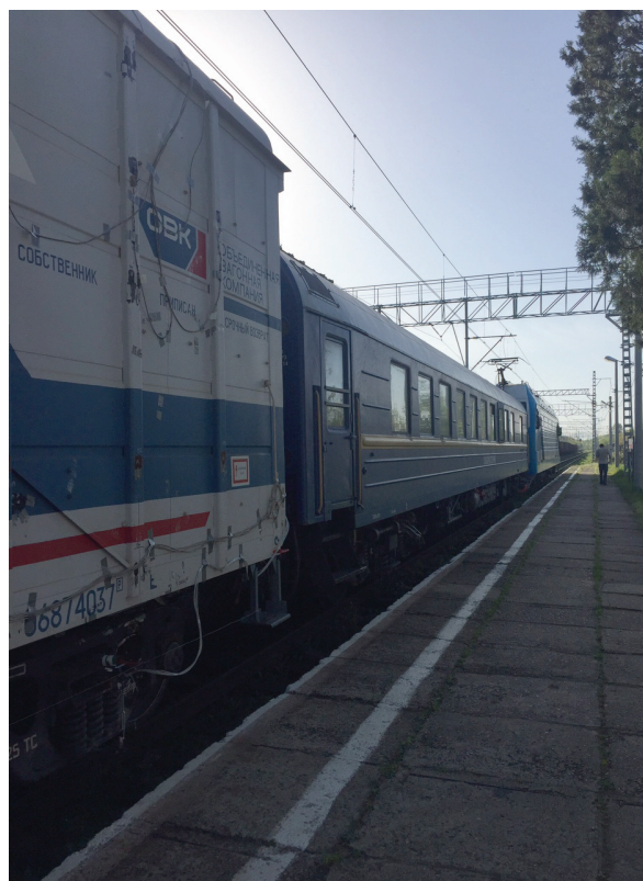
Рис. 5. Испытуемый крытый вагон в сцепе с вагон-лабораторией АО «НВЦ “Вагоны”»
