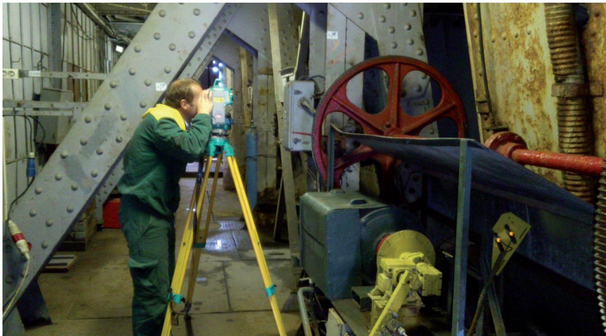
Рис. 3. Определение координат контрольных точек внутреннего оборудования
