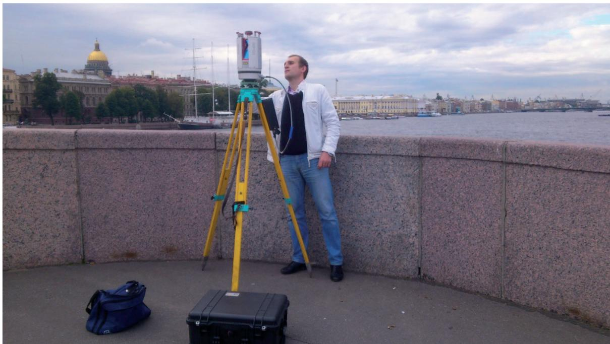
Рис. 2. Сканерная съемка внешних элементов опор
