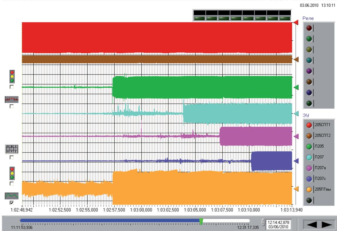
Рис. 7. Осциллограммы напряжений: отключение тяги происходит на 20 (а) и 30 м (б) дальше по ходу от знака «отключить тяговые двигатели»
