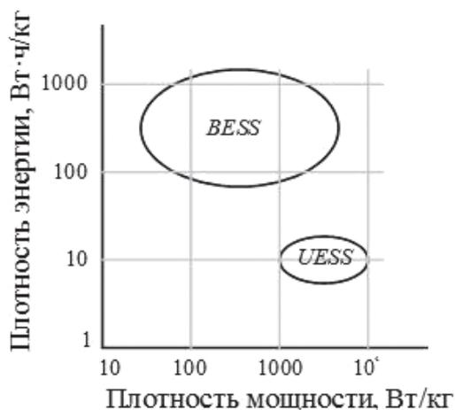
Рис. 7. Сравнение характеристик батарейной BESS и конденсаторной UESS систем хранения энергии
