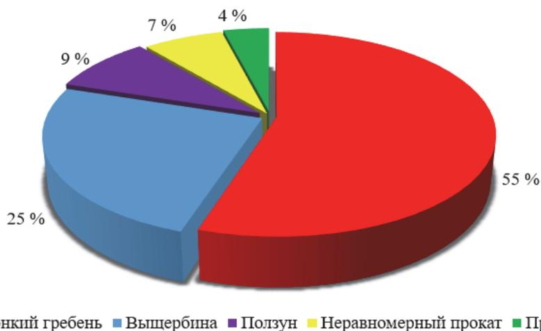
Рис. 5. Структура и причины отцепок вагонов на текущий ремонт в 2020 г. по неисправностям колесных пар
