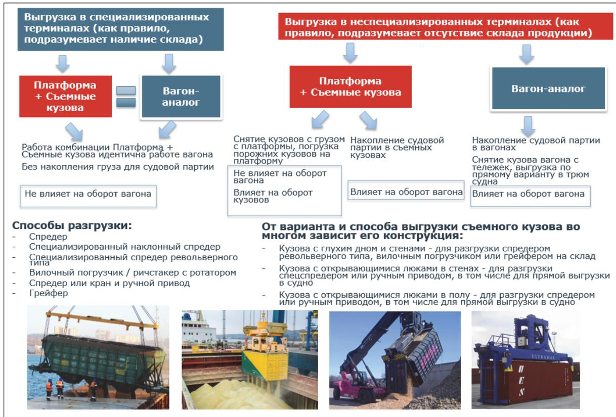
Рис. 3. Варианты и способы разгрузки съемных кузовов
