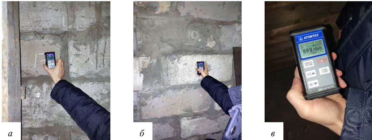
Рис. 5. Проведение измерений автоклавного золопенобетона различного состава: а и б — блоки пенобетона, в — фоновое значение (фото Е. В. Русановой)
