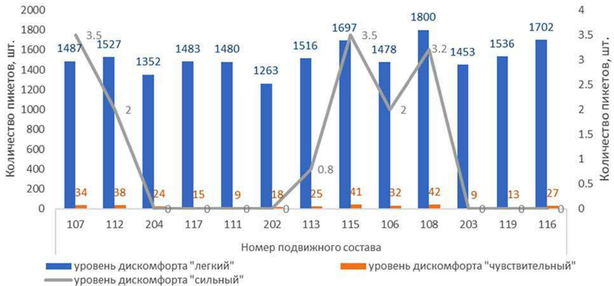
Рис. 3. Наличие пикетов пути с уровнем дискомфорта по первому главному пути направления Санкт-Петербург — Москва
