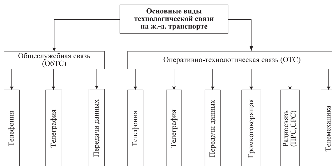
Рис. 2. Структурная схема классификации основных видов технологической связи на железнодорожном транспорте
