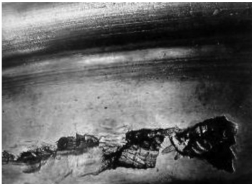
Рис. 1. Выщербины на поверхности катания колеса
