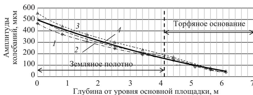
Рис. 3. Затухание амплитуд колебаний по глубине земляного полотна и торфяного основания при движении грузовых поездов (локомотив ВЛ-10)
