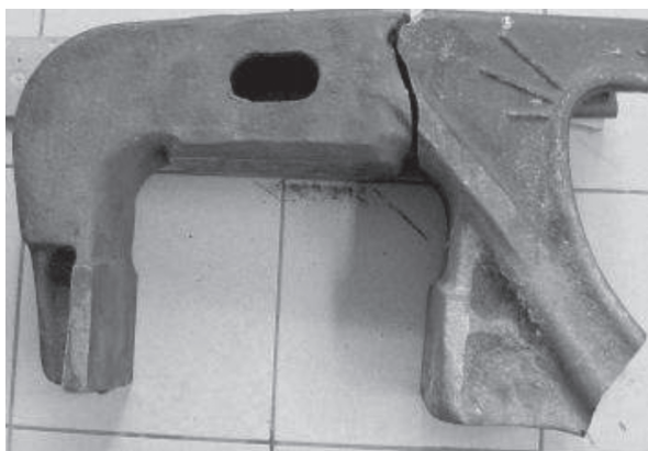
Рис. 1. Излом боковой рамы по внутреннему углу буксового проема
