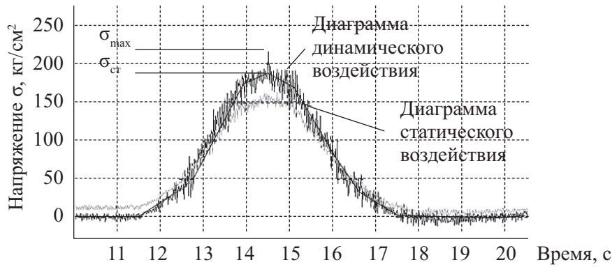
Рис. 5. Тензограмма напряжений в поясе пролетного строения
