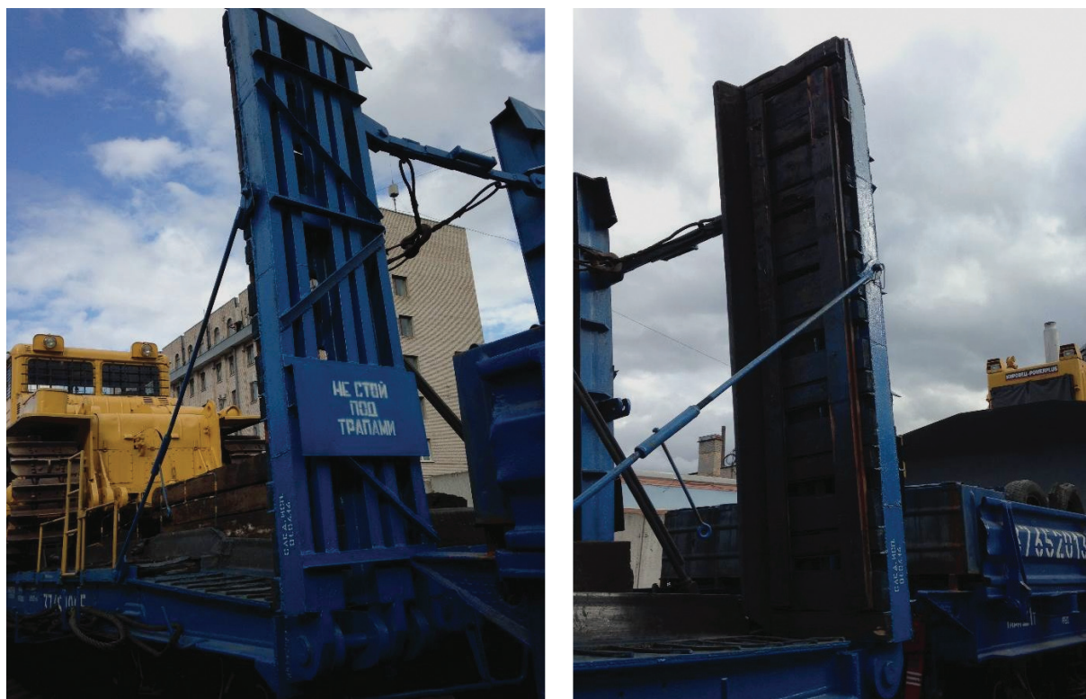
Рис. 2. Вариант откидного трапа для сгона трактора ДЭТ-250
