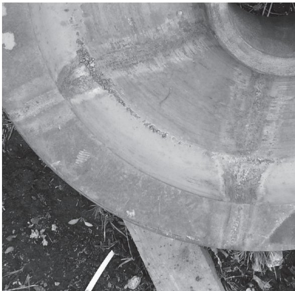
Рис. 1. Фрагмент колеса с участками закалки на внутренней стороне
